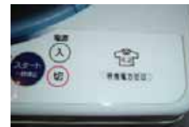
待機電力ゼロの洗濯機
